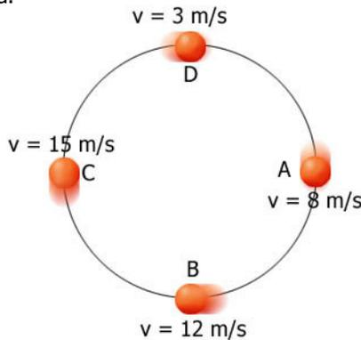
Nesse exemplo temos o módulo da velocidade aumentando, indicando aceleração tangencial. Existe também alteração na direção e no sentido, mostrando a existência da aceleração centrípeta.
